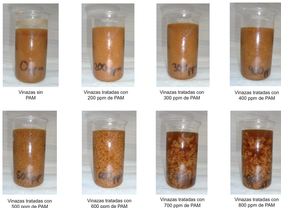
**Fig. 2.** Formación de floculos conforme se incrementa la adición de PAM
