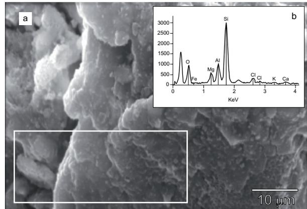
**Fig. 5** a) Micrografía de MEB de zeolita pretratada, b) Espectro EDX analizado en el recuadro.
