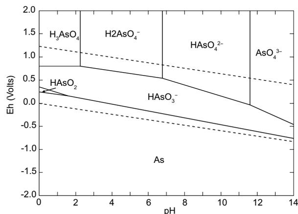
**Fig. 1.** Diagrama Eh-pH del sistema As-H<sub>2</sub>O.
