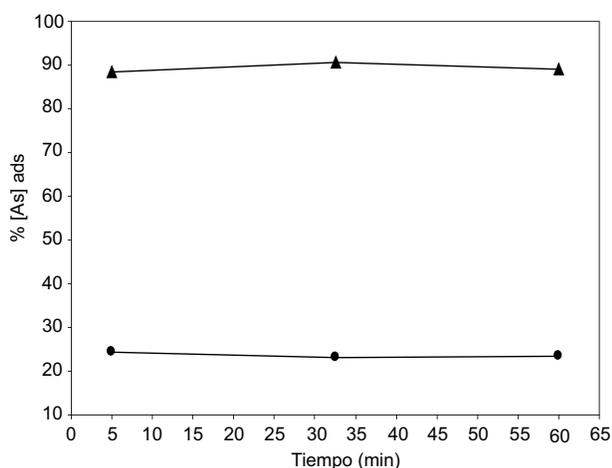
**Fig. 6.** Efecto del tiempo de contacto con el porcentaje de arsénico adsorbido en la zeolita natural (● ZSP) y zeolita pretratada (▲ ZP). Condiciones: 0.5 mg/L; zeolita 1g, pH= 7 y temperatura: 25 °C.
