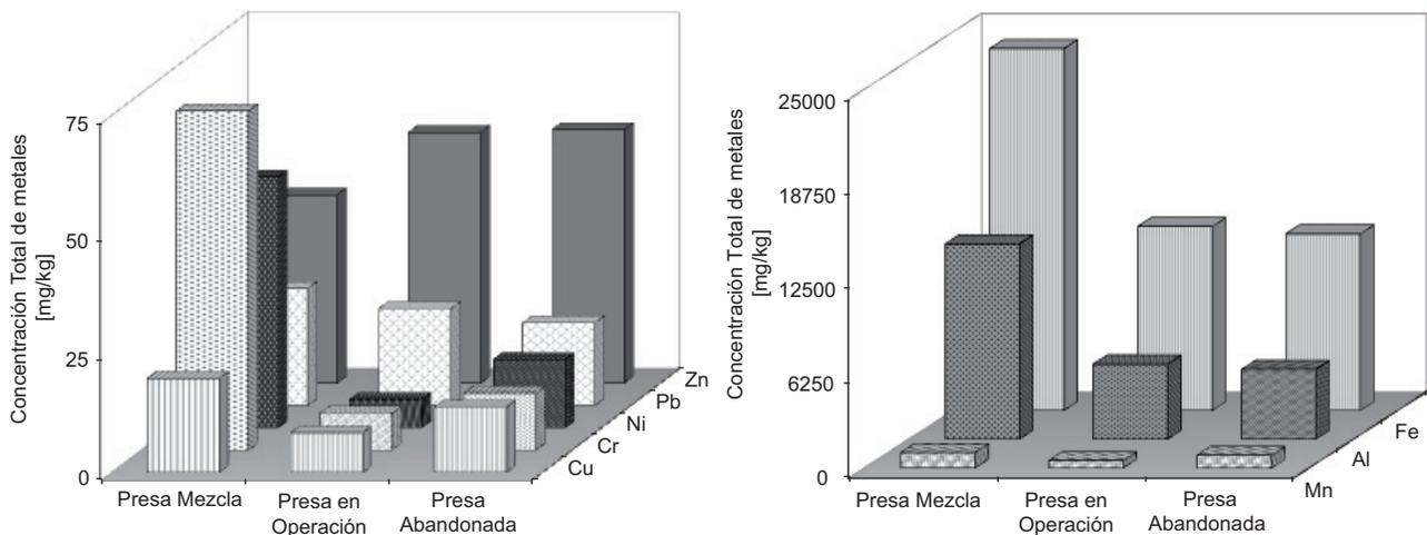
Fig. 2. Concentración total de metales Mn, Zn, Fe, Al, Cu, Pb, y Cr (mg/kg) en jales de la Presa Mezcla, Presa en Operación y Presa Abandonada del distrito minero de Guanajuato
