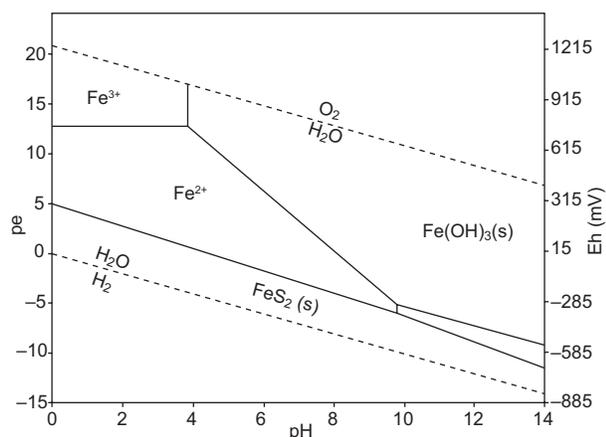
**Fig. 3.** Diagrama pe-Eh-pH del sistema Fe-H<sub>2</sub>O-S ; pFe = 6 y pS = 3. Las reacciones y constantes de equilibrio fueron obtenidas de Kehew (2001)
